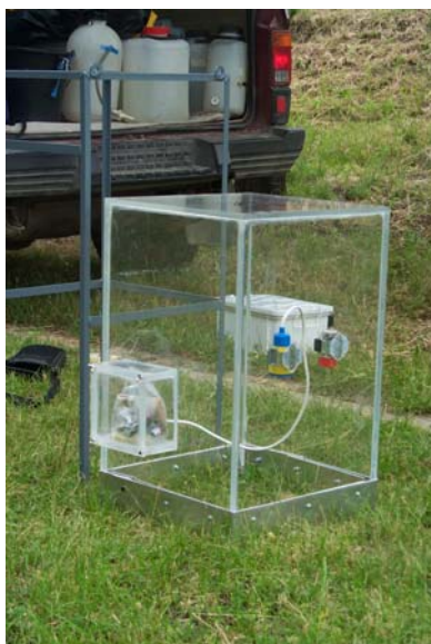
Foto 4: Respirationskammer: zusammgebaut, aber noch nicht lichtdicht für Sedimentrespirationsmessung verpackt.
