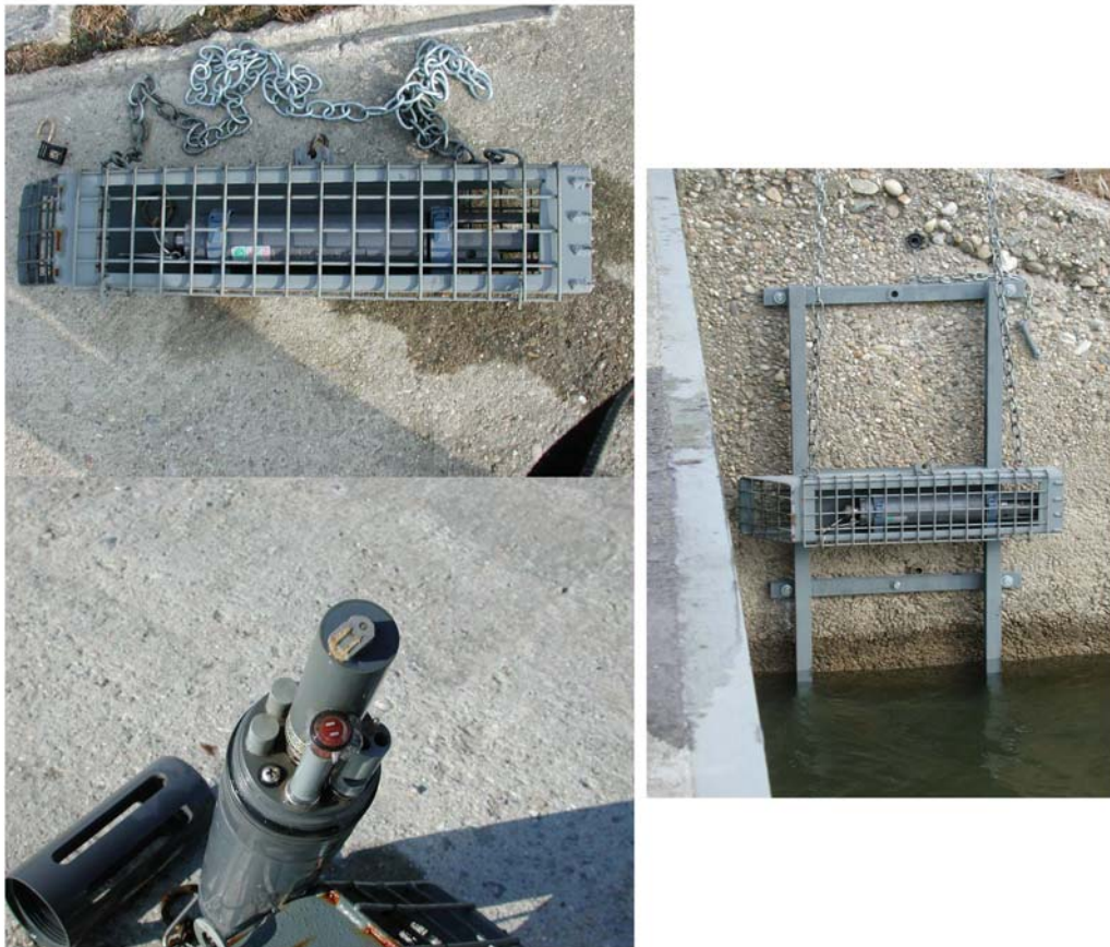
Foto 1-3: Dauermesseinrichtung (Sonde 1) für Sauerstoffmessungen beim Standort R5.
